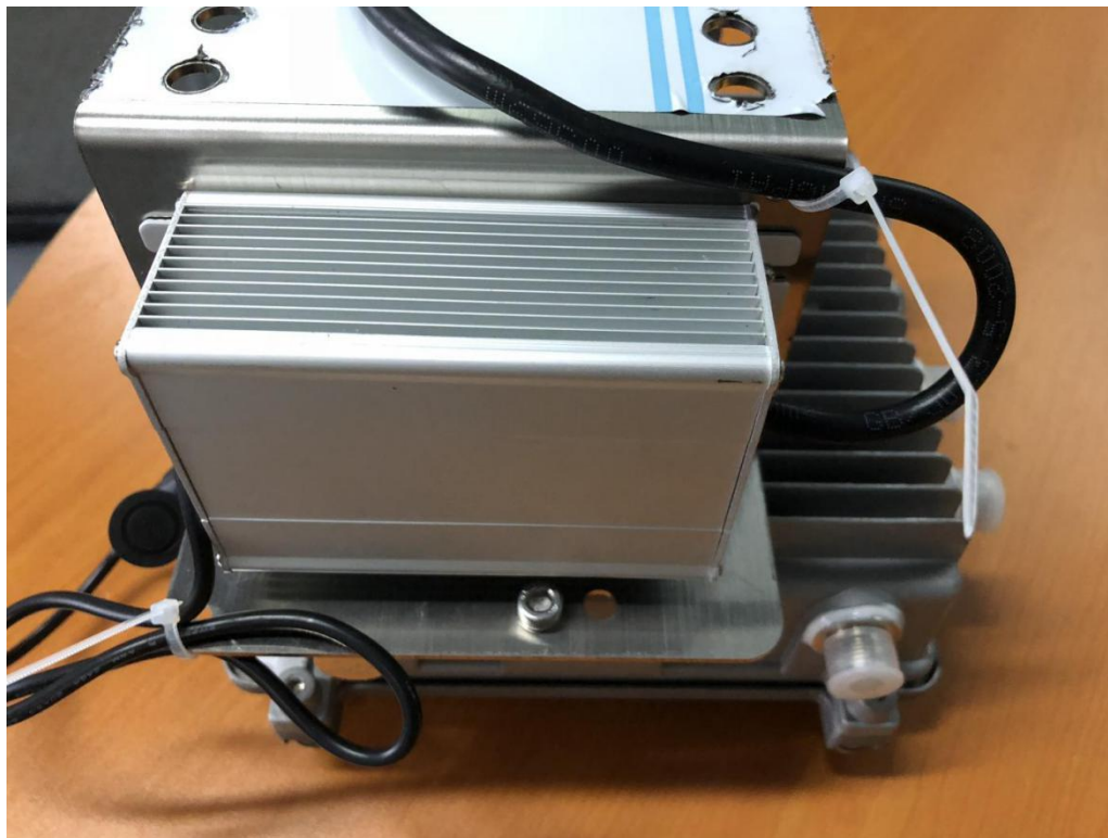
图 4-16 用扎带固定线缆
