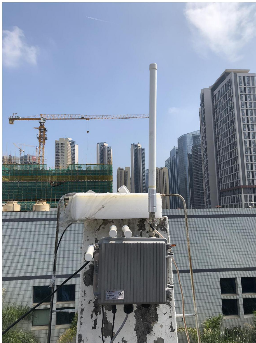
图 4-25 墙体安装整机效果图
