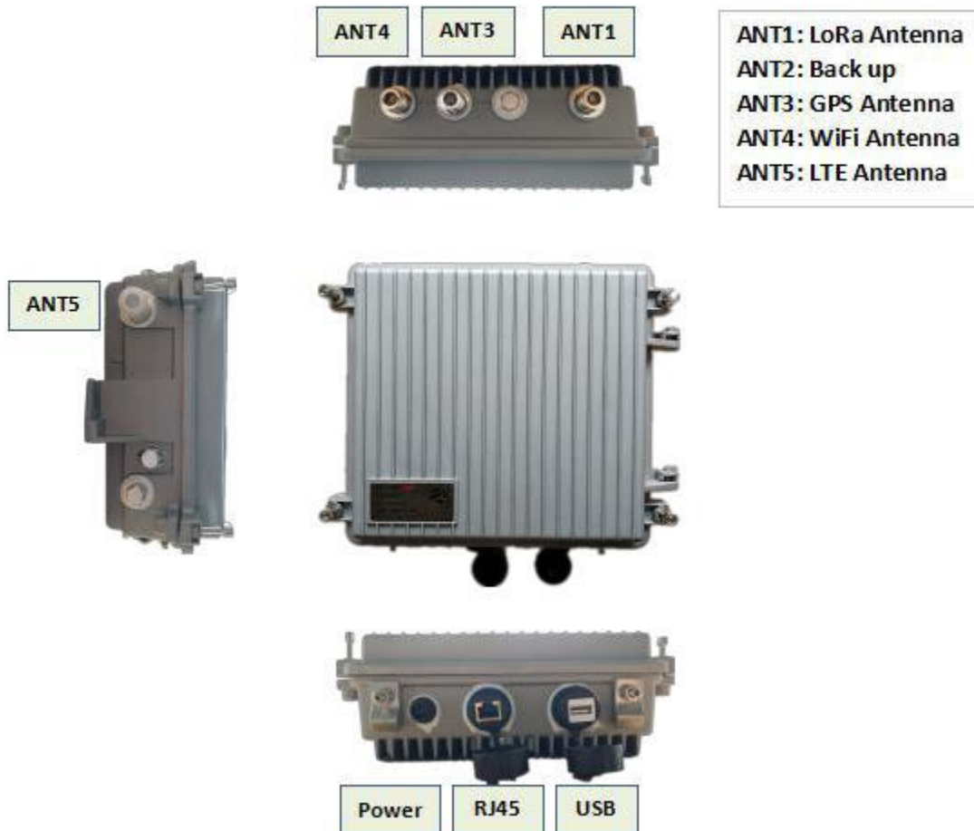
图 2-1 网关设备外部接口示意图
